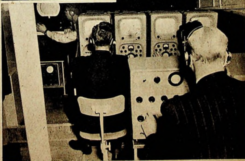
Close-up van de regelapparatuur in de reportagewagen. Vier Philips monitors, waarvan drie voor controle op het inkomende beeld (één voor elke camera) en één voor het uitgaande beeld. Geheel links een normale TV-ontvanger, waarmee het van de zenders te Lopik en te Eindhoven uitgaande beeld gevolgd werd.
