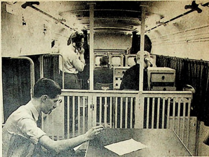
Kijkje in de Philips reportagewagen. Deze interieuroopname toont de regelkamer, enerzijds verbonden met de drie in het stadion opgestelde camera's en anderzijds met het zendertje, dat de luchtverbinding met de op de Boerentoren aanwezige „repeater" tot stand bracht.
