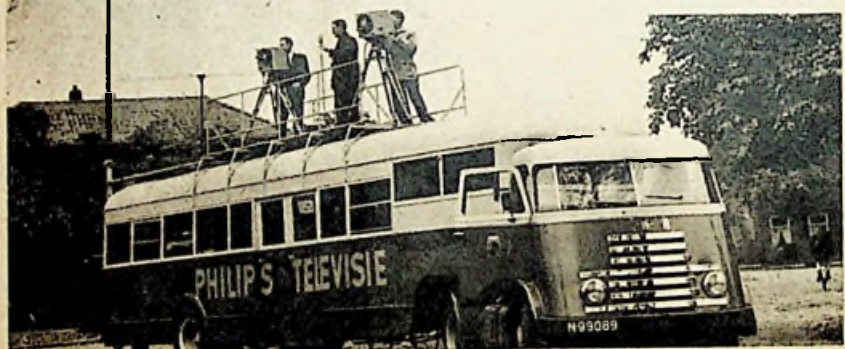
De reportagewagen. Actiefoto van dit voor buitenopnamen dienende mobiele TV-station, dat door Philips voor de duur der experimentele uitzendingen ter beschikking is gesteld van de Ned. Televisie Stichting.
